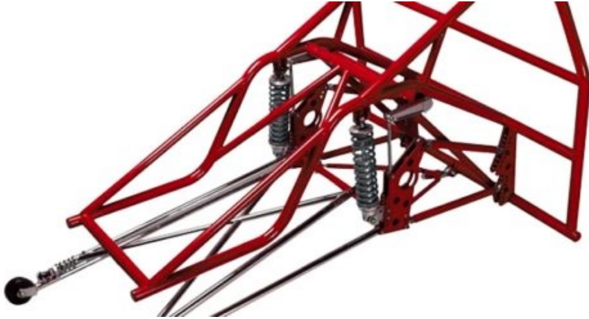
Fig. 1.2 Șasiul din oțel al unui autovehicul [6]
