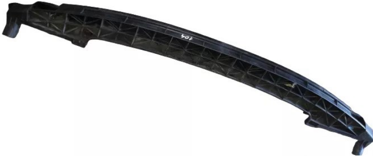
Fig. 3.9 Armătură bară de protecție din PS [65]
