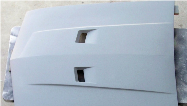
Fig. 3.25 Capotă realizată din rășină poliesterică nesaturată [85]
