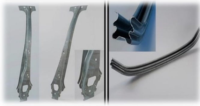
Fig. 2.10 Armătura stâlpului B și traversa barei de protecție realizată din oțel TRIP [35]
