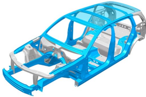
Fig. 2.7 Caroserie unui autovehicul construită din oțel DP [29]
