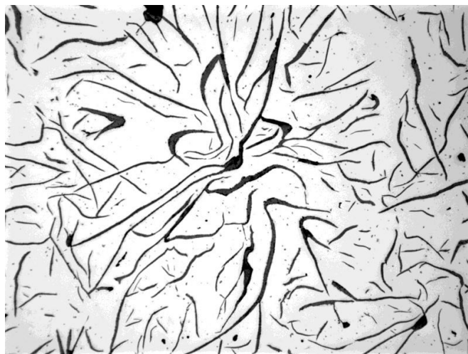
Fig. 2.13 Microstructura fontelor cenușii feritice [42]
