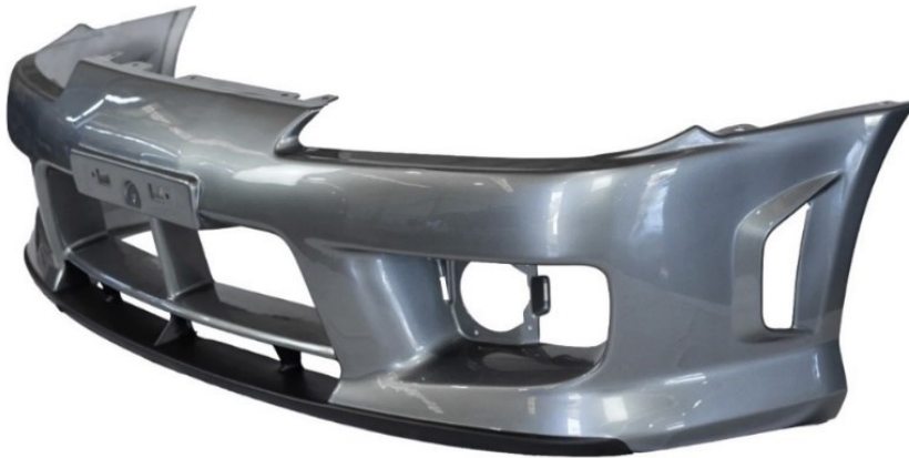
Fig. 3.12 Bare parașoc din PP [69]
