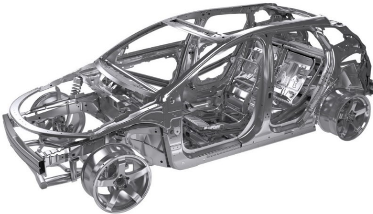
Fig. 2.11 Caroseria unui autovehicul realizată din oțel CP [38]
