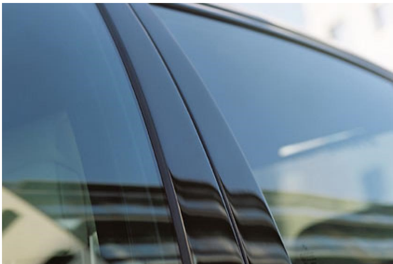
Fig. 3.7 Geam lateral din PMMA [63]
