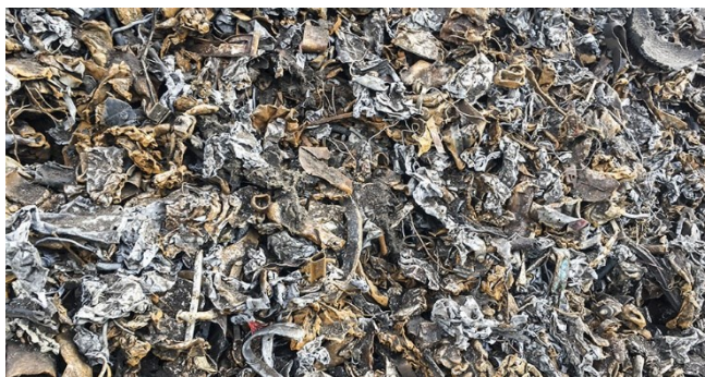
Fig. 5.5 Frația grea (metalică) rezultă din tocare a unui VSU [109]
