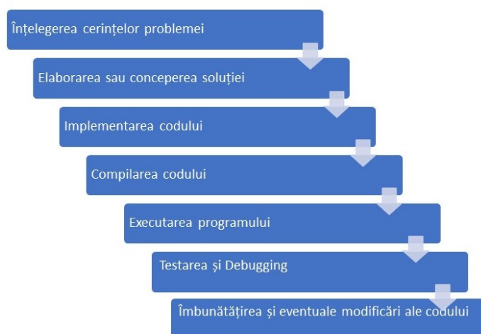
Figura 2-14. Etapele de rezolvarea a unei probleme/ dezvoltare a unui program în limbajul de programare C/C++
