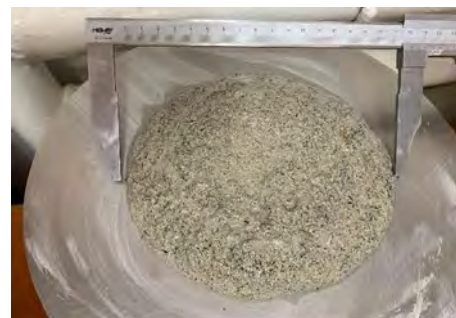
Figura 5. Consistența mortarului cu deșeuri din fulgi de cauciuc
