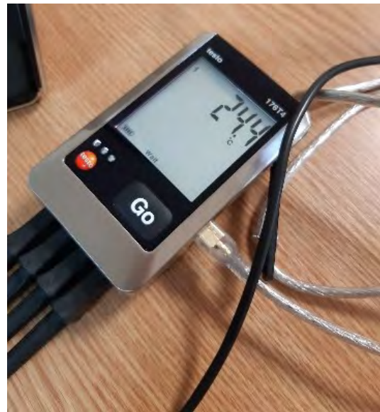
Figura 6. Placa de achiziție date temperatură (Testo 176 T4).
