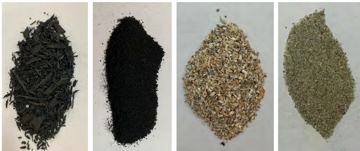
Figura 1. Deșeuri din fulgi de cauciuc Figura 2. Deșeuri din pulbere de cauciuc Figura 3. Deșeuri de scoici Figura 4. Deșeuri de sticlă
