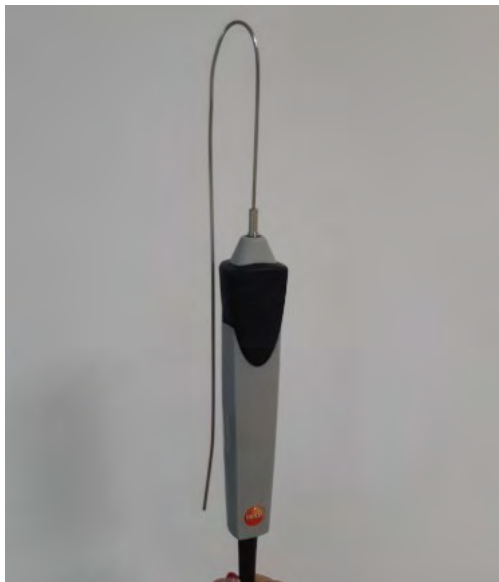
Figura 5. Senzorii utilizați - sondele de imersie TC tip K (testo).
