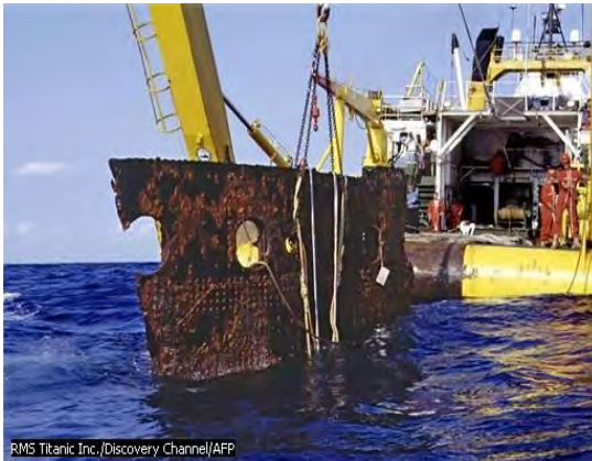
Figura 3. Efectele coroziunii asupra unor materiale feroase
