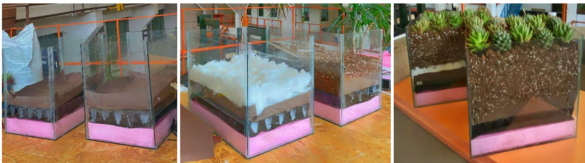
Figura 4. Aplicarea stratului anti-rădăcină, a substratului vegetal și a plantelor de Sedum .
