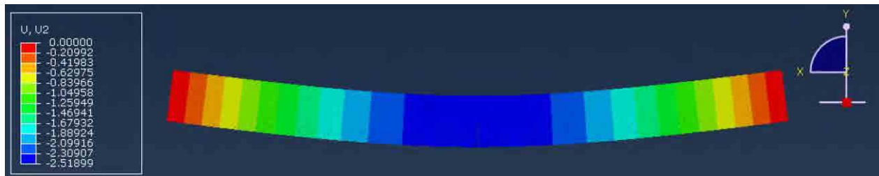
Fig. 9: Deplasarea utilizând programul Abaqus
