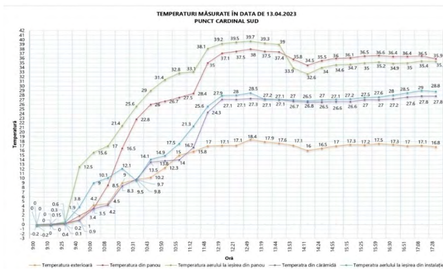
Figura 14. Temperaturi măsurate cu peretele orientat spre sud.
