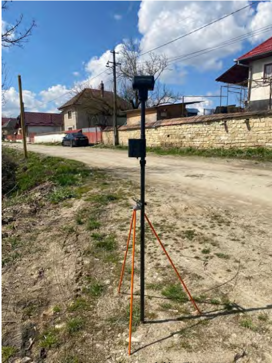
Fig. 2.2. Stația mobilă D-RTK
