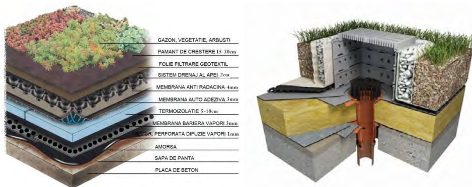
Figura 1. Stratificația unui acoperiș verde (stânga). Cămin de colectare a apelor drenate (dreapta). [4]
