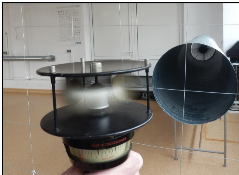
Figura 5.3 Modul de măsurare a vitezei aerului în dreptul nodurilor caroiajului cu ajutorul anemometrului cu cupe
