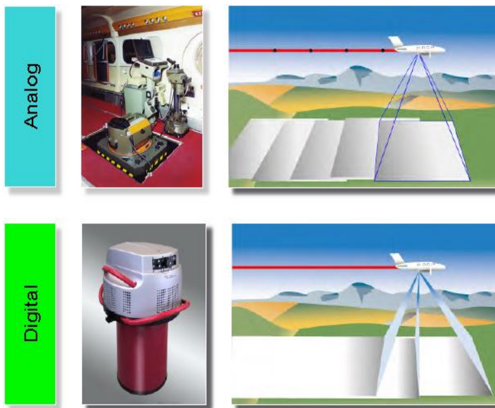
Fig. 5.6 Principiul de preluare a imaginilor aeriene cu camerele fotogrammetrice Leica analogice / digitale (sursa: GEO123.1_Lecture_13_FS2015_Photogrammetry_v1_dpi220_University of Zurich)
