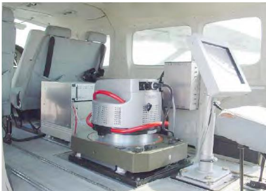
Fig. 5.5 Amplasarea camerei fotogrammetrice digitale în aparatul de zbor (sursa: GEO123.1_Lecture_13_FS2015_Photogrammetry_v1_dpi220_University of Zurich)
