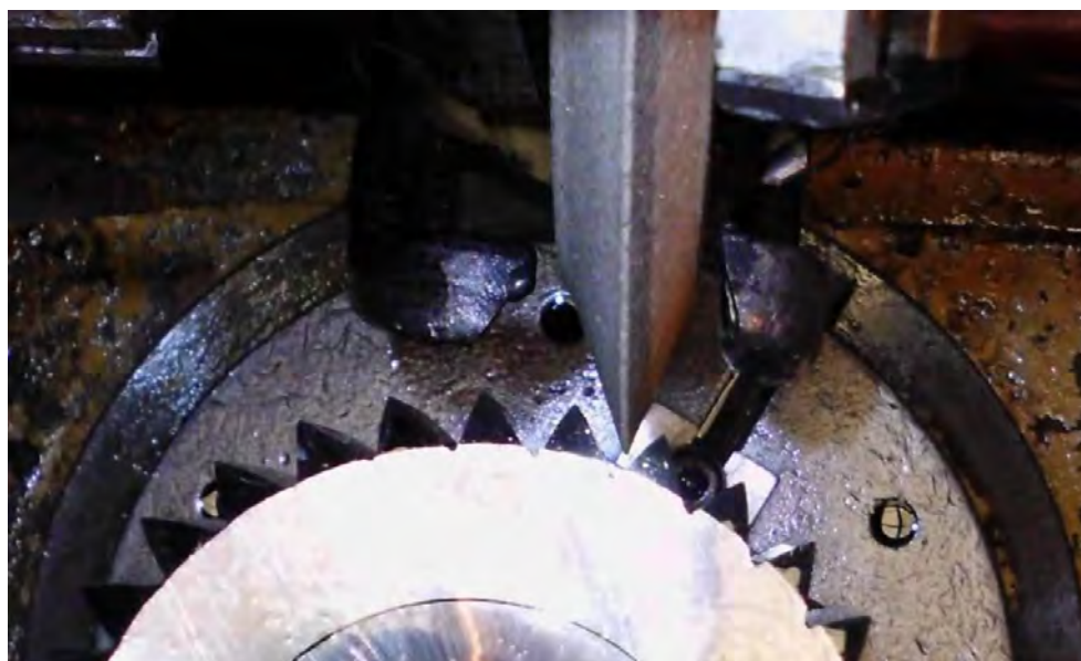
Fig. 6.40. Reglajul tehnologic de prelucrare a danturii roții dințate cu dinți asimetrici prin metoda Niles cu disc abraziv biconic cu semiunghiul de 20^\circ
