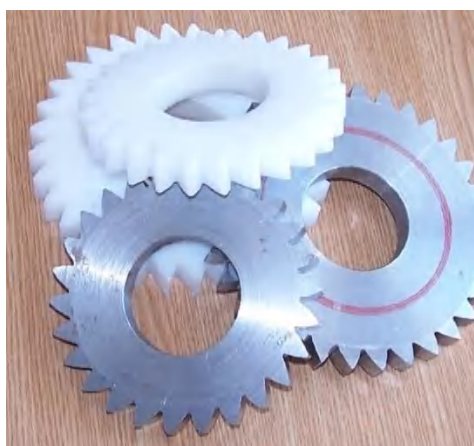
Fig. 6.13. Roți dințate cu dinți asimetrici fabricate prin frezare cu freze disc modul pentru dinți asimetrici
