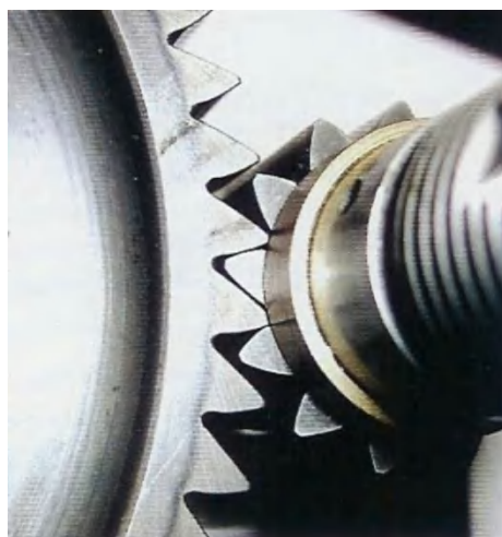
Fig. 1.1. Roți dințate cu dinți asimetrici (Yang, 2007), (Kapelevich, 2007).
