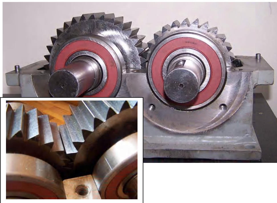
Fig. 6.41. Reductor cu roți dințate cu dinți asimetrici (prototip)
