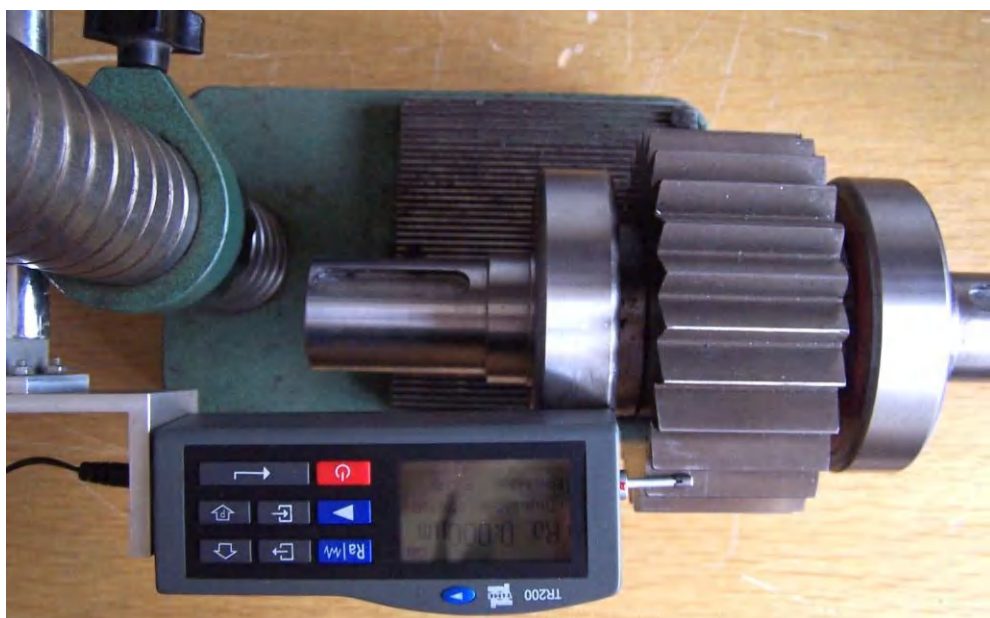
Fig. 6.39.a. Măsurarea rugozității flancului roții dințate cu dinți asimetrici
