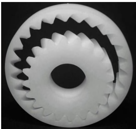
Fig. 1.1. Roți dințate cu dinți asimetrici (Yang, 2007), (Kapelevich, 2007).
