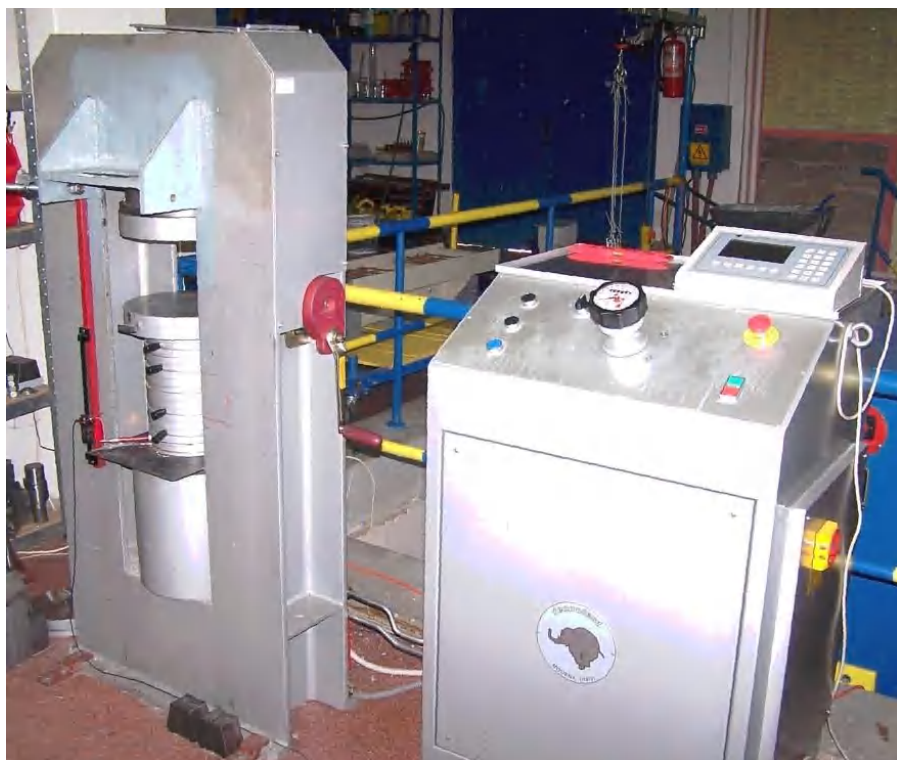
Fig. 3.4. Mașina de încercat materiale F050/TC a firmei Tecnotest.
