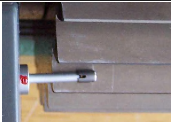
Fig. 6.39.b. Măsurarea rugozității flancului roții dințate cu dinți asimetrici, Detaliu palpator.
