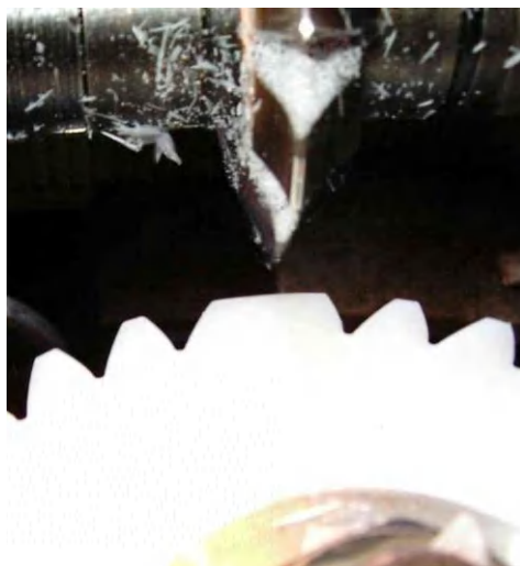
Fig. 6.29. Sistem tehnologic de prelucrare a danturii roților cu dinți asimetrici prin frezare cu freză disc profilată
