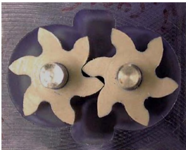
Fig. 1.2. Pompă cu roți dințate cu dinți asimetrici dintr-un echipament medical (Kapelevich & Kleiss, 2002), (Kapelevich & McNamara, 2005)
