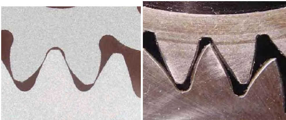
Fig. 1.9. Angrenaj cu dinți simetrici și asimetriți, (Kapelevich, 2004)
