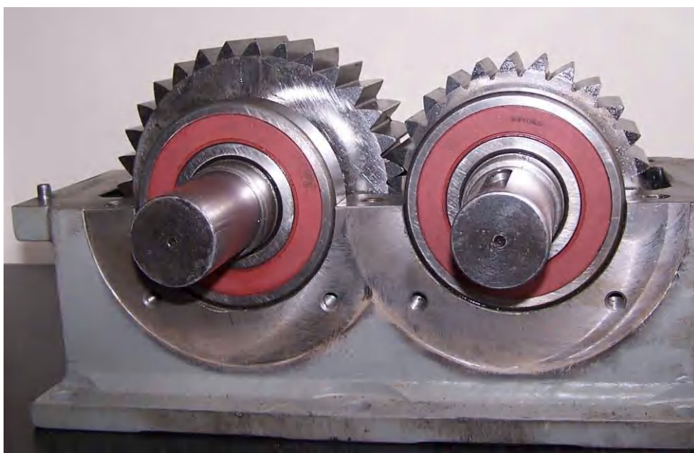
Fig. 5.3. Reductor prototip cu roți dințate cu dinți asimetrici
