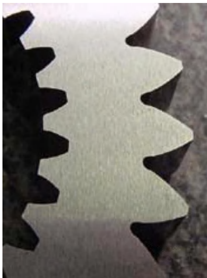
Fig. 1.4. Roata solară a reductorului planetar cu roți dințate asimetrice, (Kapelevich, 2007)
