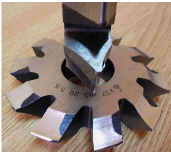
Fig. 6.28. Freze disc modul pentru roți dințate cu dinți asimetrici
