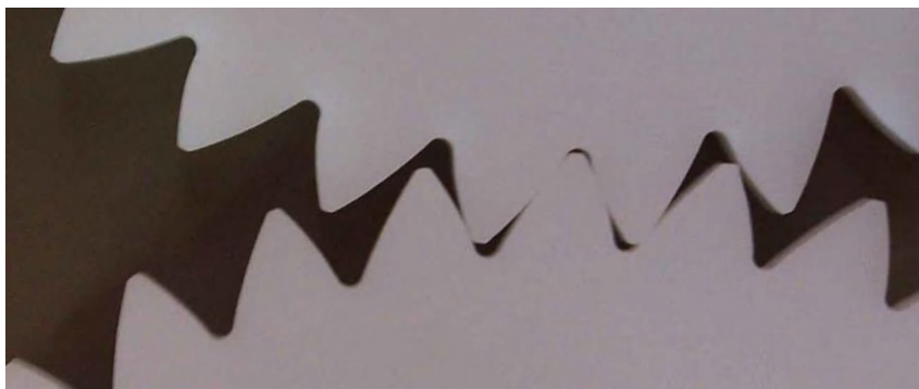
Fig. 2.1. Angrenaj format din roți dințate cu dinți asimetrici (Ravai Nagy & Lobonțiu, 2010)
