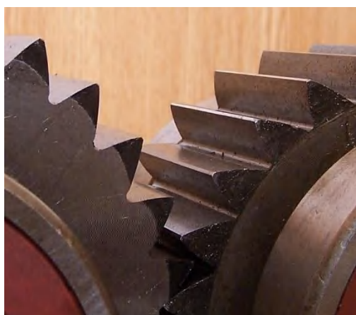
Fig. 6.14. Roți dințate cu dinți asimetrici rectificată cu disc abraziv biconic, prin metoda Niles
