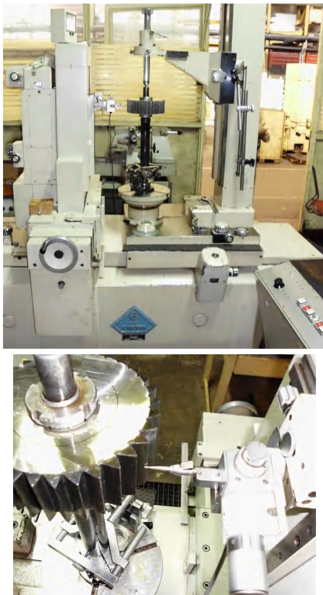
Fig. 6.37. Mașina de control a roților dințate, evolvometrul, Klingelnberg P.F.S.U.640 și utilizarea acestuia la controlul roții dințate cu dinți asimetrici
