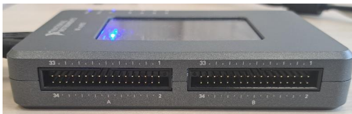
Figura 7.1 – myRIO™, amplasarea celor două porturi de extensie: MXP A și B
