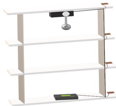
Figura 12.1 – Stand experimental cu myRIO™, senzori și servomotor cu greutate
