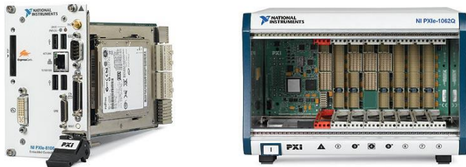
Figura I.2 – Controler PXI™, șasiul și magistrala de comunicație între module
