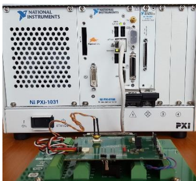
Figura 9.1 – Standul de testare, calculatorul PXI™ și modulul cu LED-uri albe de putere
