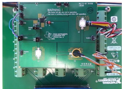
Figura 9.1 – Standul de testare, calculatorul PXI™ și modulul cu LED-uri albe de putere
