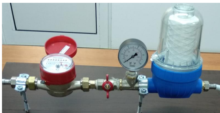
Fig. 2.8 Stand de încercare a cartușelor filtrante în condiții de laborator
