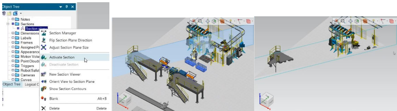
Figura 9.4. Vizualizarea modelului 3D secționat conform planului definit
