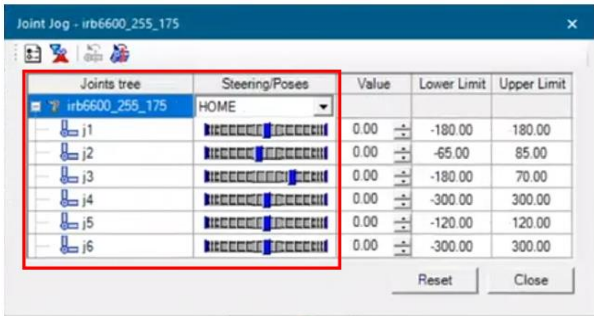
Figura 7.2. Cele 6 axe ale mecanismului robotului
