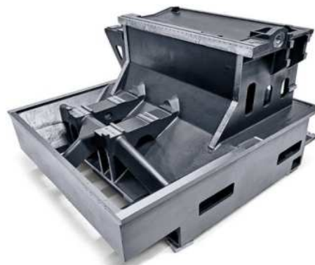
Fig. 2.5 Batiu monolitic din fontă al mașini de frezat M1 (DMG Mori, n.d.)
