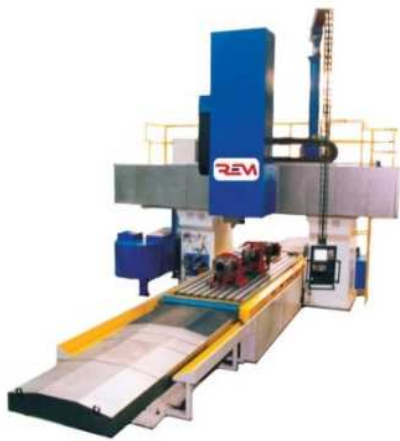
Fig. 2.6 Mașină CNC de frezat portal FLP 2200 (REM, 2021)
