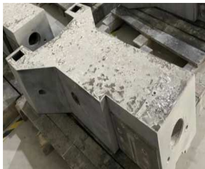
Fig. 2.12 Coloană din compozit mineral de pentru m-u CNC [43]
