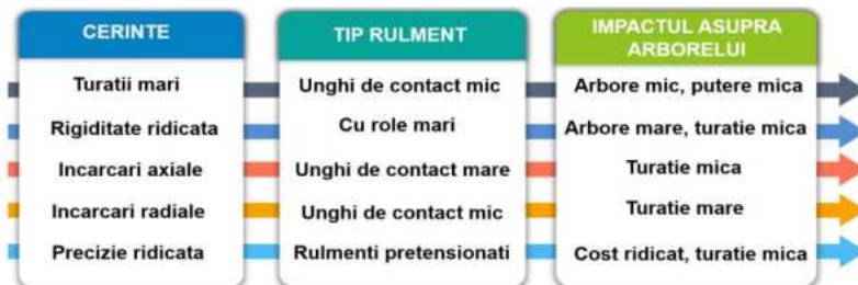
Fig. 2.25 Impactul asupra arborelui în funcție de cerințe și tipul de rulment
