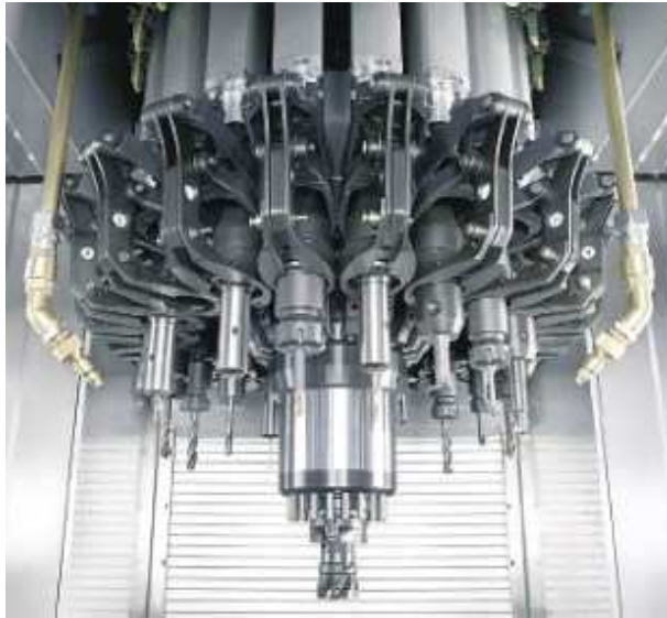
Fig. 2.88 Sistem de schimbare a sculelor, „Chiron basket” pentru centre de prelucrat verticale ( Chiron, 2021)
