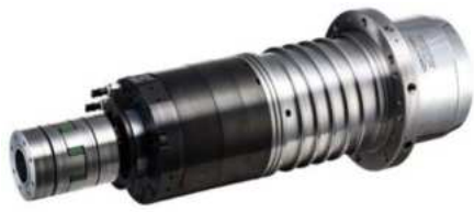
Fig. 2.42 AP cu antrenare directă de la motor prin cuplaj (SolPower, n.d.)
