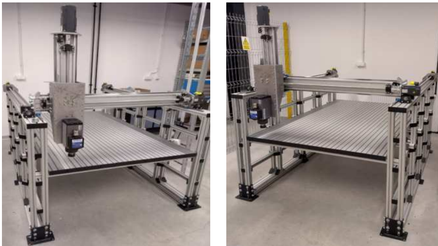
Fig. 7.3 Execuția practică a router-ului CNC în variantă modulară și reconfigurabilă
