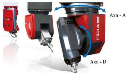
Fig. 2.18 AP de frezat cu două grade de libertate (Fidia, n.d.)
