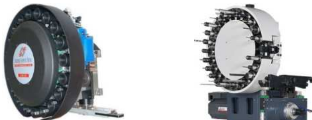
Fig. 2.86 ATC cu magazie de tip disc și braț: vertical sau orizontal [103]
