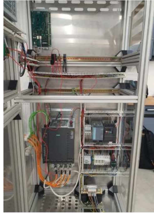
Fig. 5.12 Dulap automatizare router CNC - cu componentele aferente
