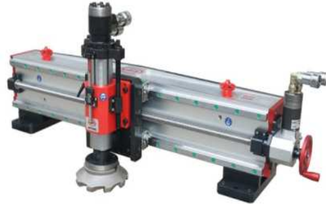
Fig. 2.9 Traversă din aluminiu pentru axa X a unei m-u de frezat portabile
