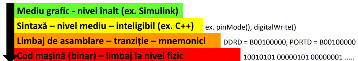
Fig. 1.7 – Metode și limbaje de programare specifice lucrului cu microcontrolere Ilustrarea procesului de compilare
