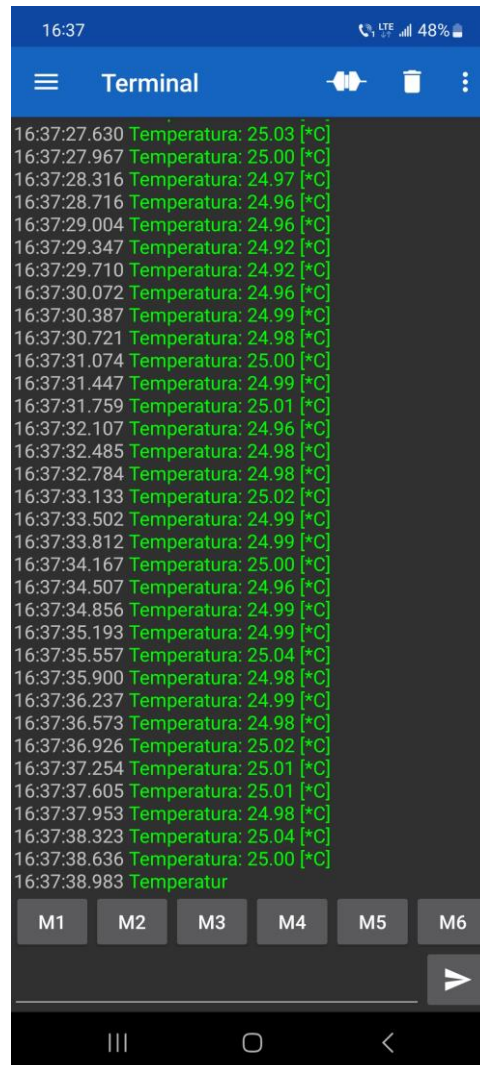
Fig. 5.19 – Aplicația Bluetooth Serial Terminal – vizualizarea conținutului consolei serial
