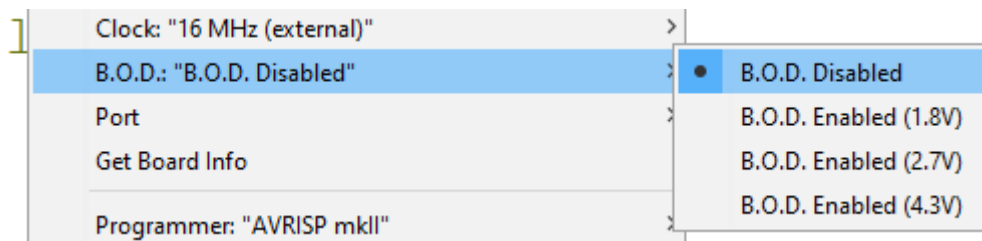
Fig. 1.18 – Alegerea nivelului minim al tensiunii de alimentare
