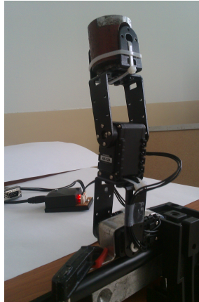
Figura 3.2: Robotul cu două cuple de rotație din [25]
