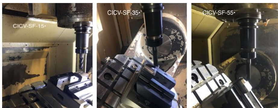
Fig. 4.24 Prelucrarea suprafeței cilindrice concave cu freza sferică în cazul celor 3 tipuri de înclinări
