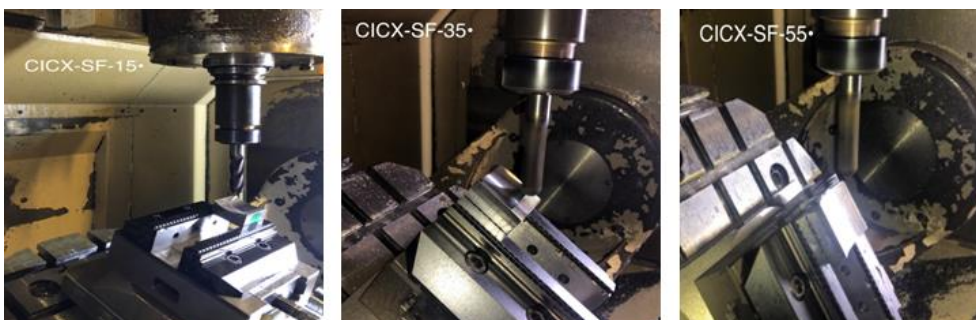
Fig. 4.29 Prelucrarea suprafeței cilindrice convexe cu freza sferică în cazul celor 3 tipuri de înclinări
