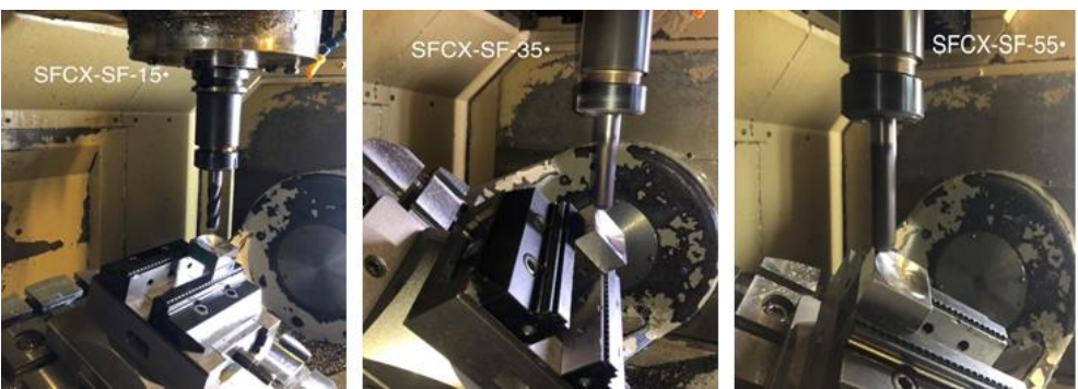
Fig. 4.19 Prelucrarea suprafeței sferice convexe cu freza sferică în cazul celor 3 tipuri de înclinări
