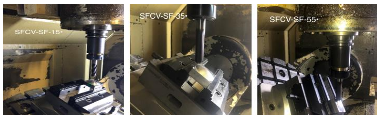
Fig. 4.14 Prelucrarea suprafeței sferice concave cu freza sferică în cazul celor 3 tipuri de înclinări
