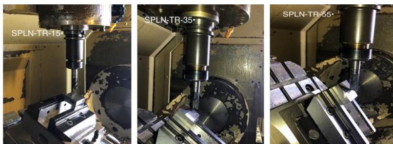
Fig. 4.8 Prelucrarea suprafeței plane cu freza toroidală în cazul celor 3 tipuri de înclinări
