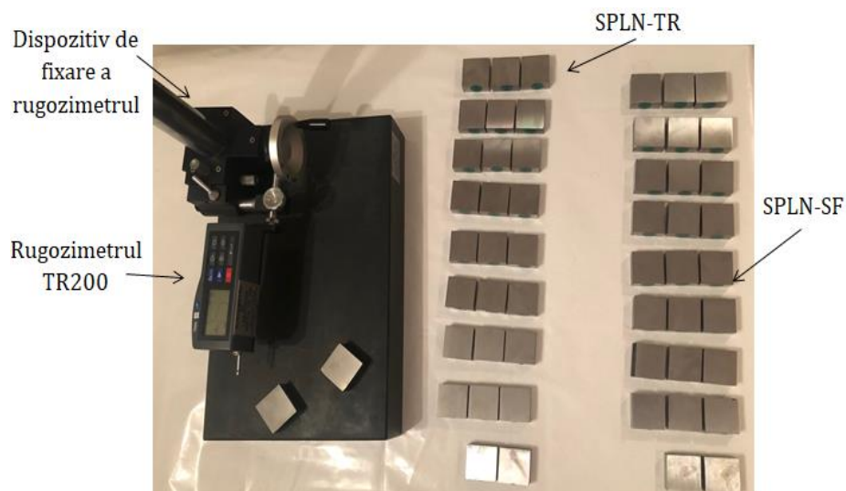
Fig. 4.10 Suprafețele plane prelucrate cu cele două tipuri de freze pregătite pentru măsurare
