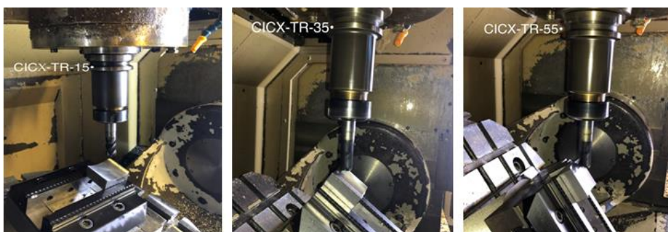
Fig. 4.28 Prelucrarea suprafeței cilindrice convexe cu freza toroidală în cazul celor 3 tipuri de înclinări
