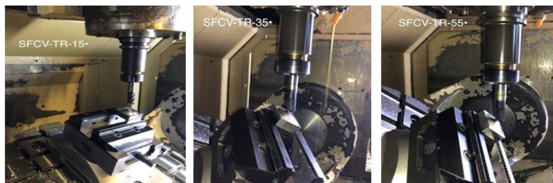
Fig. 4.13 Prelucrarea suprafeței sferice concave cu freza toroidală în cazul celor 3 tipuri de înclinări
