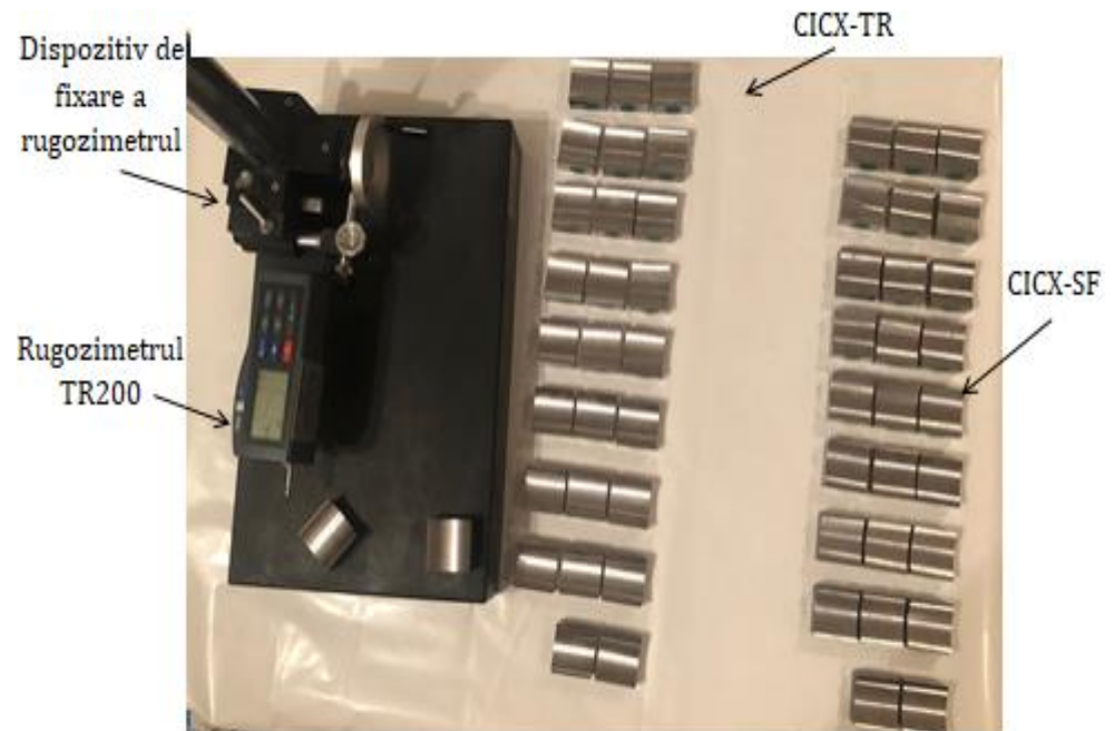
Fig.4.30 Suprafețele cilindrice convexe prelucrate cu cele două tipuri de freze pregătite pentru măsurare
