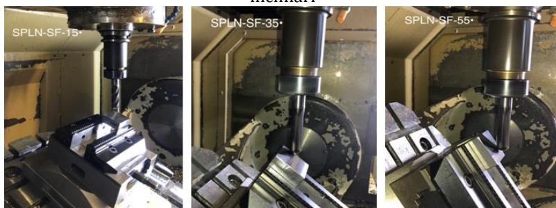
Fig. 4.9 Prelucrarea suprafeței plane cu freza sferică în cazul celor 3 tipuri de înclinări
