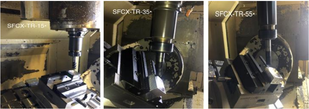
Fig. 4.18 Prelucrarea suprafeței sferice convexe cu freza toroidală în cazul celor 3 tipuri de înclinări
