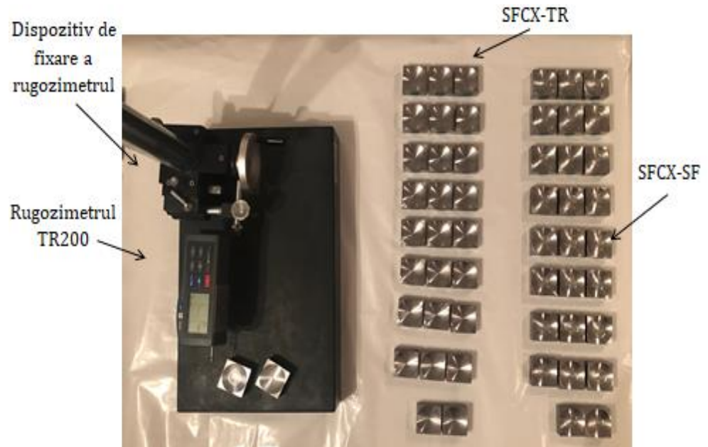
Fig. 4.20 Suprafețele sferice convexe prelucrate cu cele două tipuri de freze pregătite pentru măsurare
