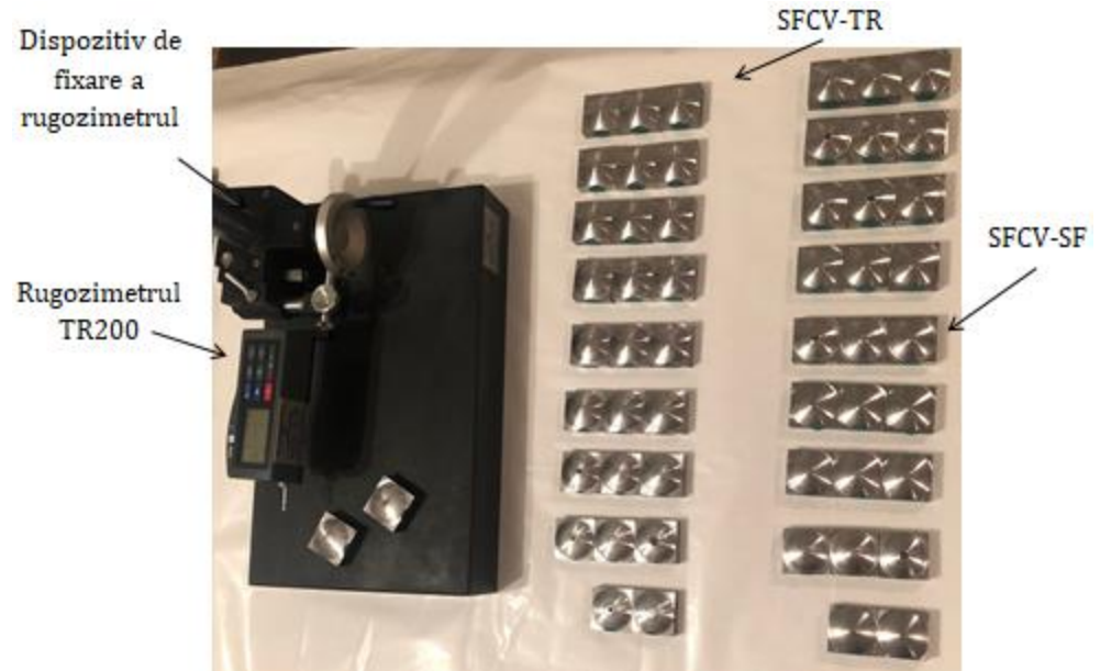
Fig.4.15 Suprafețele sferice concave prelucrate cu cele două tipuri de freze pregătite pentru măsurare
