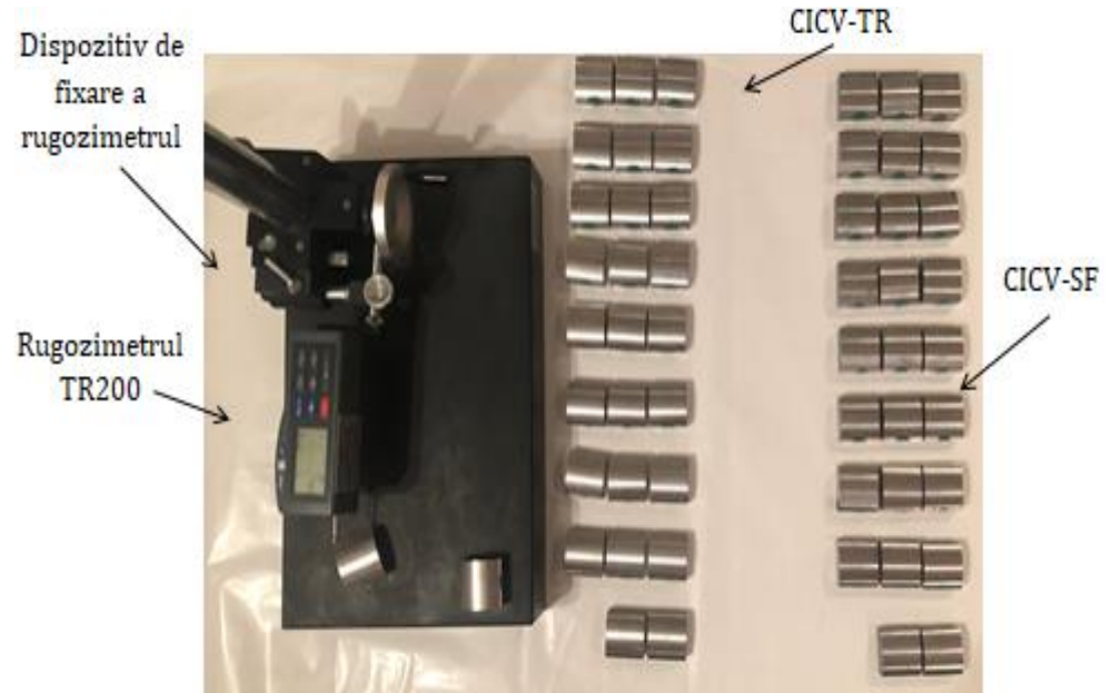
Fig. 4.25 Suprafețele cilindrice concave prelucrate cu cele două tipuri de freze pregătite pentru măsurare
