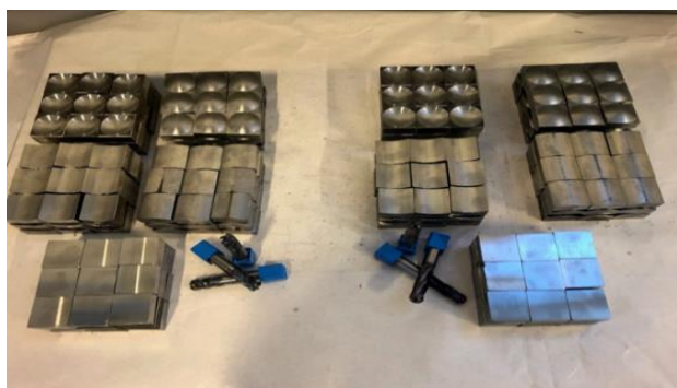
Fig. 4.5. Cele 270 de plăcuțe pregătite pentru operația de finisare
