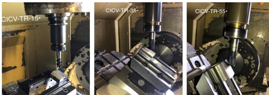
Fig. 4.23 Prelucrarea suprafeței cilindrice concave cu freza toroidală în cazul celor 3 tipuri de înclinări
