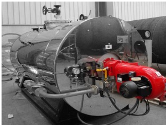
Fig.7.5 – Boilere cu abur [59]
