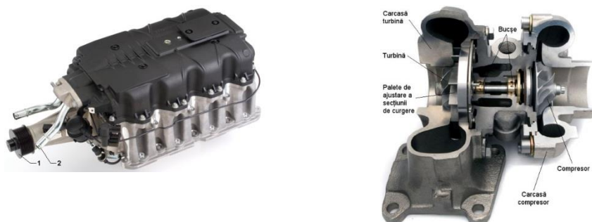
Figura 2.22 Metode de supraalimentare a motoarelor cu ardere internă [17]
