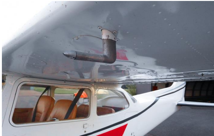
Figura 2.13 Tubul Pitot-Prandtl montat pe fuzelaj [8]
