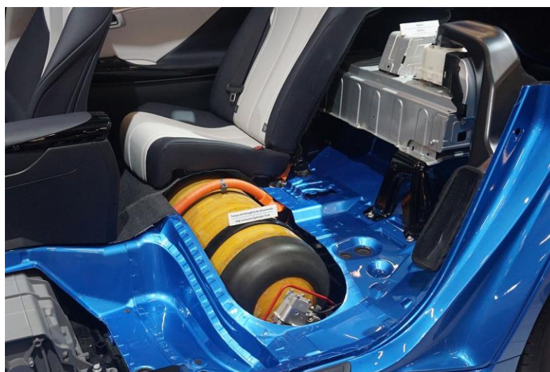
Figura 4.1 Rezervor pentru stocarea hidrogenului comprimat pentru Toyota Mirai [19]
