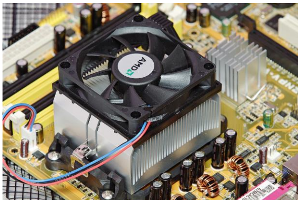
Figura 10.6 Răcirea unui procesor cu radiator și ventilator [34]
