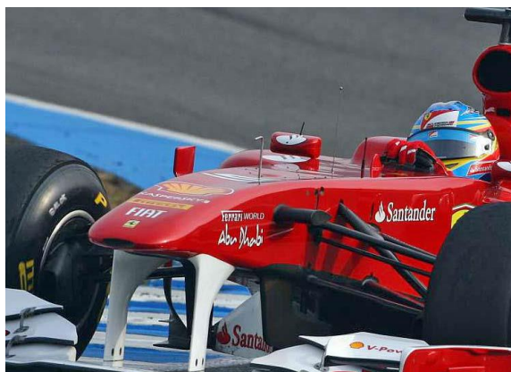
Figura 2.18 Amplasare tub Pitot pe o mașină Formula 1 [13]
