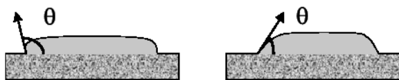
Fig. 2.2 Unghiul de contact ( \theta ) la interfața substrat-film (R.W. Schwartz, J.A. Voigt, B.A. Tuttle, D.A. Payne, T.L. Reichert, 1997)
