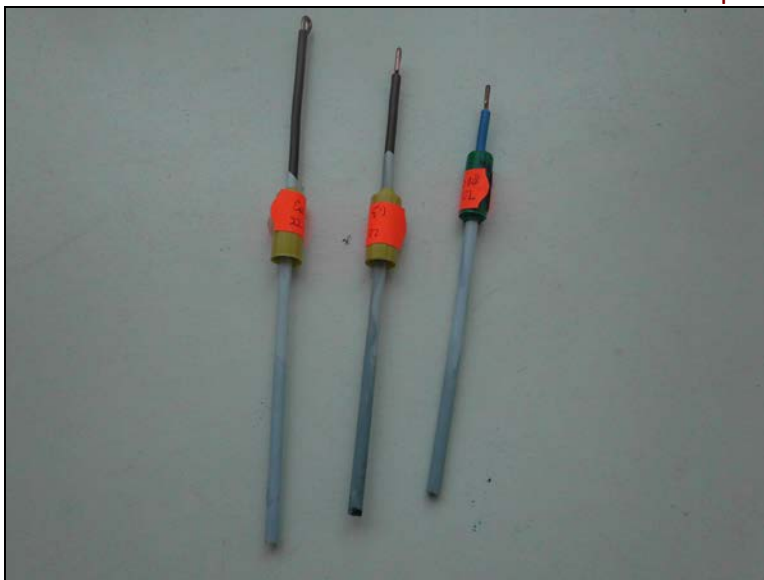
Figura nr. 3.4.1.1. Prezentarea formei constructive a electrozilor din pastă de cărbune
