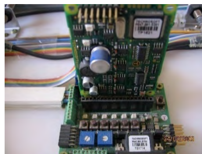
Fig. 15.6 Placa DSP a sistemului de control al mișcării ISCM 4085 Technosoft
