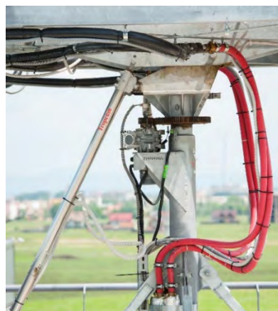
(d) Stand cu sistem de orientare biaxial pentru optimizarea algoritmilor de orientare
