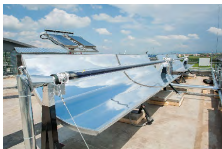
(e) Stand pentru teste de coroziune accelerată a colectoarelor solare (stânga) și colectoare concentratoare (dreapta)
