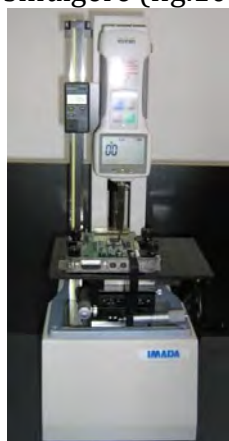
Fig.10.18 Stand pentru testarea componentelor electronice la forfecare și smulgere
