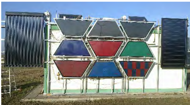
Fig. 8.14. Colectoare solare trapezoidale testate în condiții reale (proiect EST IN URBA)
