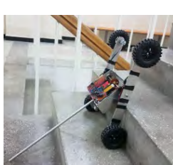
Fig.10.13 Robot de salvare în situații de urgență –RSU GEX2017: a) prototip-vedere frontală; b) vedere laterală
