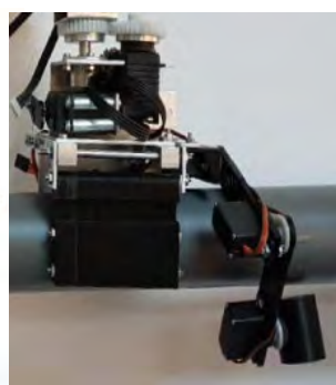
Fig.10.7b Robot pentru inspecția și monitorizarea externă a conductelor pentru petrol și gaze
