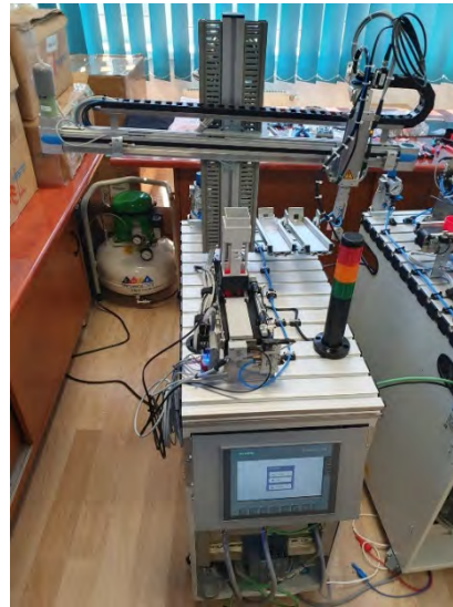
Fig. 9.11. Stand pentru extragerea și manipularea reperelor cilindrice – elemente componente
