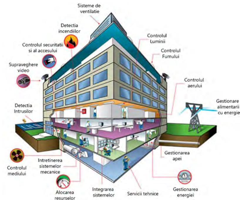
Fig. 2.23. Structura unei clădiri inteligente
