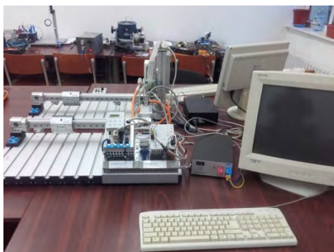
Fig. 16.3 Stand cu motor pas cu pas Festo DTC Step TP800, [2] și foto laborator FIM.
