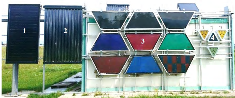
Fig. 8.16. Colector solar triunghiular testat în condiții reale (proiect SOL TRI COL)
