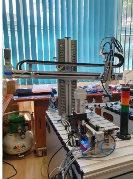
Fig. 9.10. Stand pentru extragerea și manipularea reperelor cilindrice
