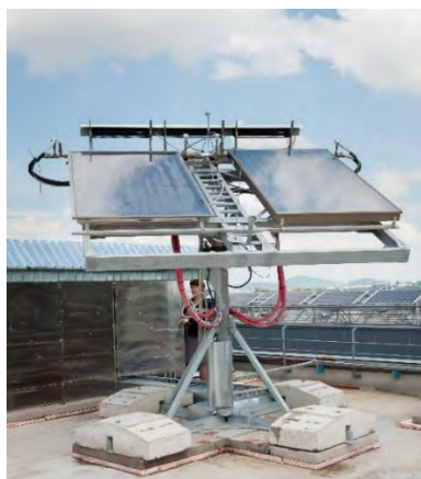
(d) Stand cu sistem de orientare biaxial pentru optimizarea algoritmilor de orientare
