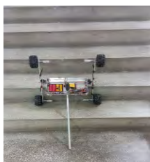
Fig.10.13 Robot de salvare în situații de urgență –RSU GEX2017: a) prototip-vedere frontală; b) vedere laterală
