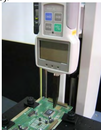
Fig.10.18 Stand pentru testarea componentelor electronice la forfecare și smulgere
