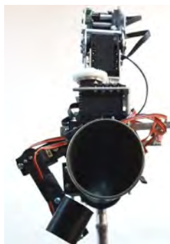
Fig.10.7b Robot pentru inspecția și monitorizarea externă a conductelor pentru petrol și gaze
