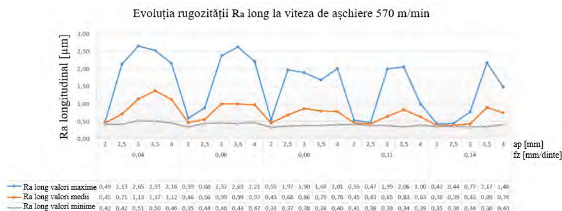
Fig. 3.45. Influența vitezei de așchiere de 570 m/min, asupra rugozității Ra long
