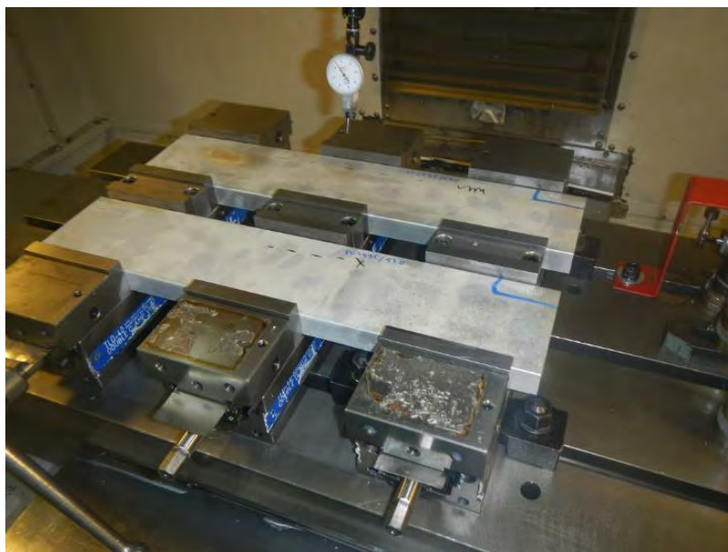
Fig. 3.3. Fixarea semifabricatelor pe mașina unealtă cu comandă numerică
