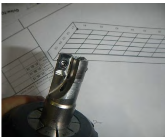
Fig. 3.5. b) Freza cilindro-frontală cu cele două plăcuțe utilizată la desfășurarea experimentelor
