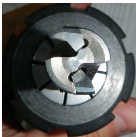
Fig. 3.5. b) Freza cilindro-frontală cu cele două plăcuțe utilizată la desfășurarea experimentelor
