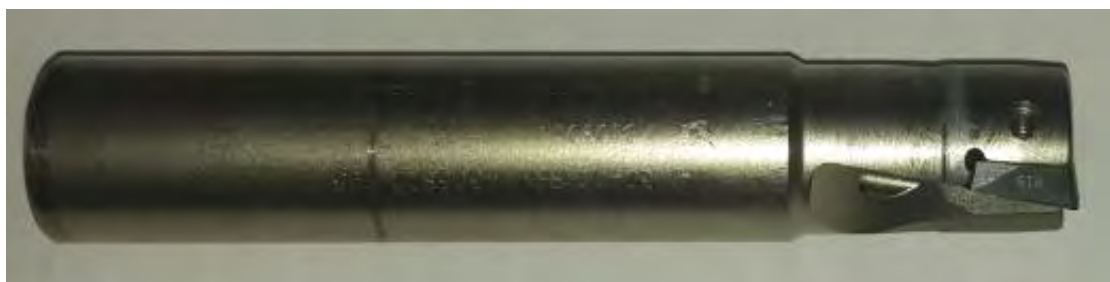
Fig. 2.8. Scula de tip SECO R217.69-1616.0-09-2AN utilizată la desfășurarea experimentelor
