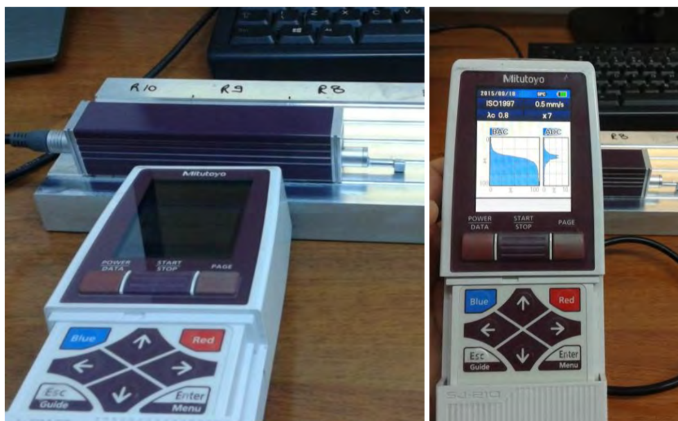
Fig. 3.7. Efectuarea măsurătorilor cu rugozimetrul Mitutoyo SURFTEST SJ-210
