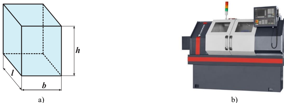
Fig. 1.5. Corpuri masive sau blocuri: a) Schematizare; b) Batiul unei maşini unelte CNC [29]
