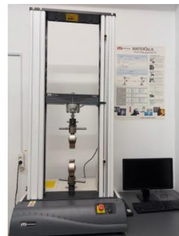
Fig. 1.25. Mașina de încercări mecanice Instron 3366 din laboratorul UTCN [26, 34]
