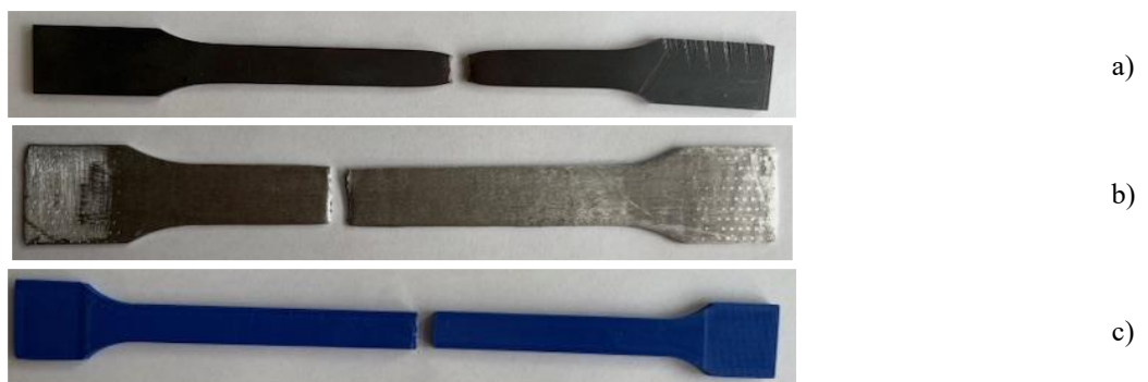
Fig. 1.27. Epruvete solicitate la tracțiune: a) epruvetă metalică; b) epruvetă din aluminiu; c) epruvetă din plastic
