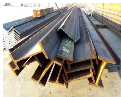
Fig. 1.3. a) Bară dreaptă cu secțiunea dreptunghiulară: Forma schematizată; b) Profil IPN [27]
