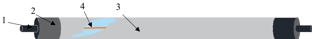
Figura 6.13. Lampă tubulară din cuarț opac pentru IR medii. 1- pin alimentare, 2- manșon din material electroizolant, 3 – tub cuarț opac, 4 – filament Cr-Ni
