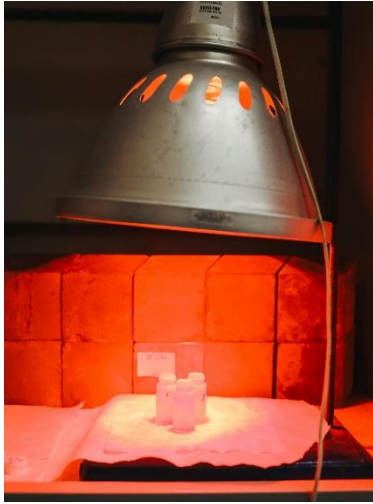
Lampă cu radiații IR folosită în laborator pentru încălzirea mostrelor
