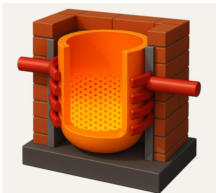
Figura 7.7.* Cuptor cu creuzet – versiune 3D
