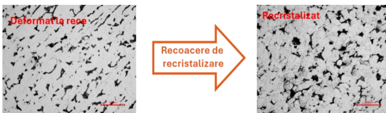
Figura 37. Modificarea structurii prin recrystalizare. Structură inițială (grăunți ecruisați) – a și după recrystalizare (grăunți echiacși) – b.
