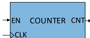
Figura 1. 5 Simbolul unui numărător sincron pe frontul ascendent cu semnal EN de activare (enable) a numărării
