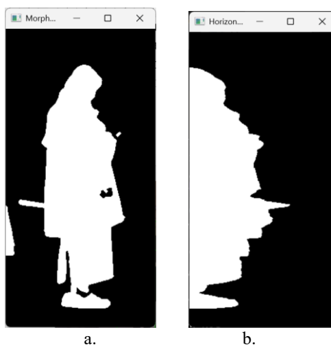
Fig. 12.5. Exemplu cu rezultate intermediare al procesărilor efectuate pentru corecția limitei de jos a detecției (dreptunghiului care încadrează persoana): a. Regiunea aferentă persoanei după binarizare și filtrare morfologică; b. Reprezentare vizuală a vectorului proiecției orizontale.
