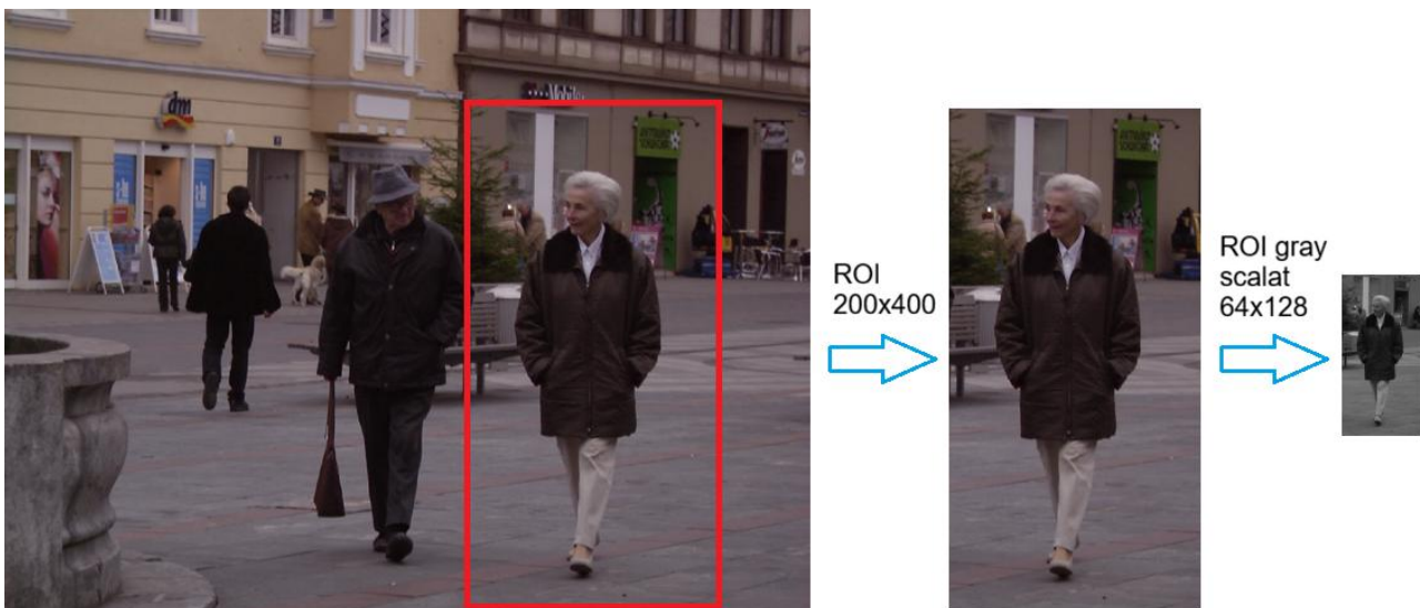
Fig. 12.1. Ilustrare a procesului de extragerea regiunilor de interes ROI cu o fereastră glisantă, scalarea și conversia acestora în grayscale.
