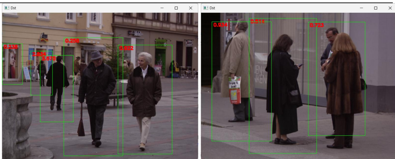
Fig. 12.4. Rezolvarea cazurilor de detecție multiplă prin fuziunea detecțiilor conform metodei propuse la pasul 2.
