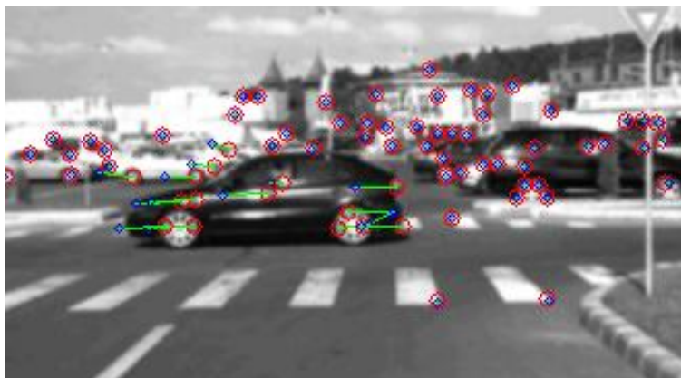
Fig. 6.5. Afișarea rezultatelor estimării câmpului de mișcare obținut prin metoda LK piramidală pentru un scenariu cu un vehicul care traversează o intersecție de la dreapta spre stânga.
