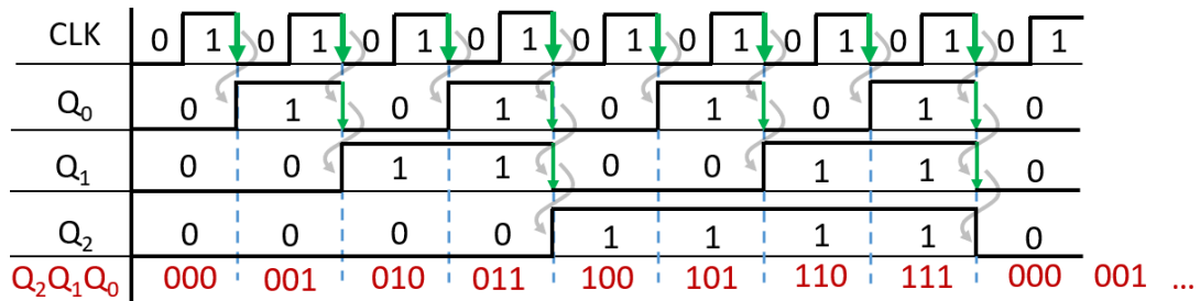
Figura 9. 2 Diagrama de funcționare a numărătorului binar asincron direct, pe 3 biți
